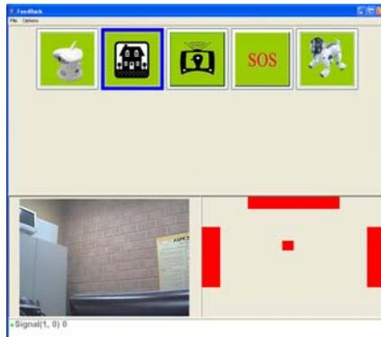
**Figure 2.** L'interfaccia di Feedback è suddivisa in tre pannelli. Nel pannello superiore sono disponibili sotto forma di icone i comandi utilizzabili. Nel pannello inferiore destro, viene visualizzato il feedback del BCI. Nella pannello inferiore sinistro invece viene visualizzato l'eventuale stream video.
